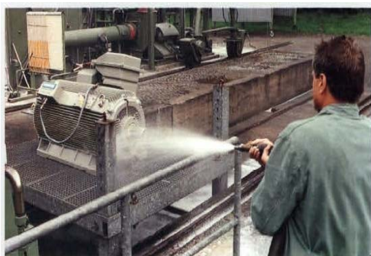
รูปที่ 5 ระหว่างทดสอบ IPx6 ด้วยการฉีดน้ำที่แรงดัน 1 บาร์ ด้วยปริมาณ 100 ลิตร/นาที
